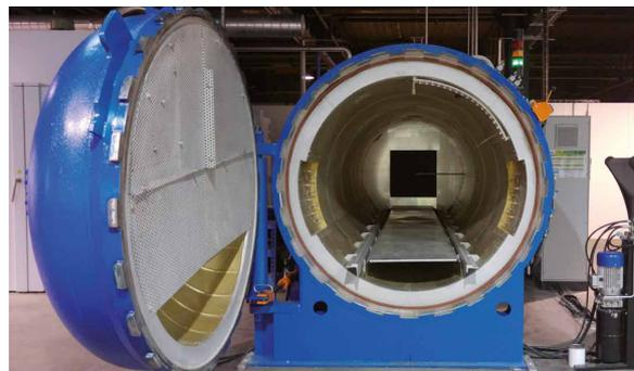
Cet investissement a pour but de répondre à la demande croissante de nos clients dans le développement et la fabrication de pièces structurales en composites. Cet autoclave vient compléter nos moyens existants nous permettant ainsi de mettre en œuvre différents procédés de fabrication (machine injection RTM, Etuve, Presse). Ce nouvel équipement nous permet ainsi de fournir un processus de polymérisation efficace en combinant température, pression et vide.
