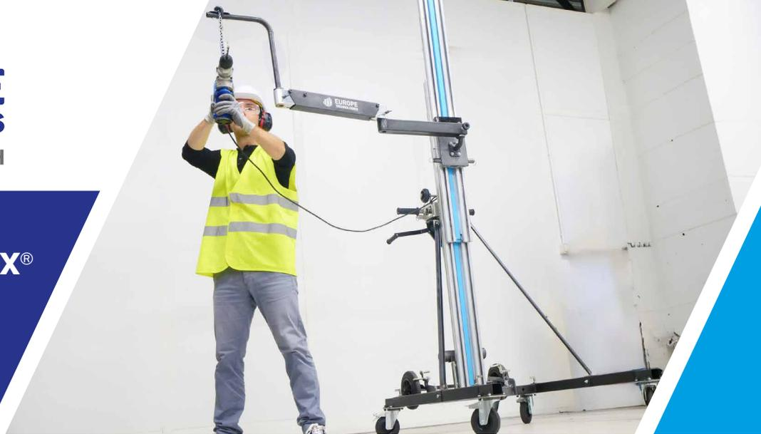
Le GRAVIT-X® est un **bras mobile d'assistance au port d'outils** parfaitement adapté aux chantiers du BTP, aux ateliers et aux usines. Robuste et modulable, il est utilisable avec la plupart des outils professionnels : burineur, visseuse, ponceuse, meuleuse, sertisseuse...
