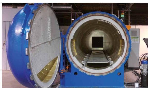
Cet investissement a pour but de répondre à la demande croissante de nos clients dans le développement et la fabrication de pièces structurales en composites. Cet autoclave vient compléter nos moyens existants nous permettant ainsi de mettre en œuvre différents procédés de fabrication (machine injection RTM, Étuve, Presse). Ce nouvel équipement nous permet ainsi de fournir un processus de polymérisation efficace en combinant température, pression et vide.
